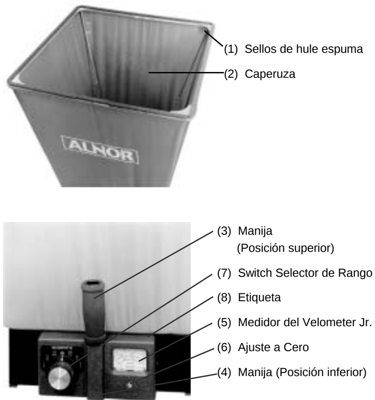
Figura 7: Características y controles del instrumento—vista frontal
