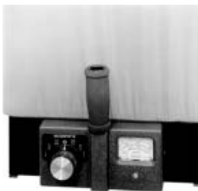
Figure 5: Position et installation de la poignée
